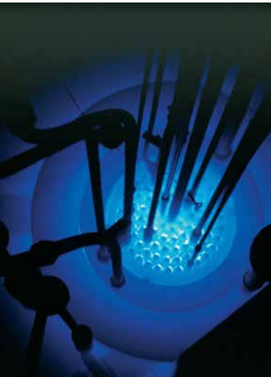
Reaktorin sydän hohtaa sinistä valoa ydinreaktion ollessa käynnissä.
